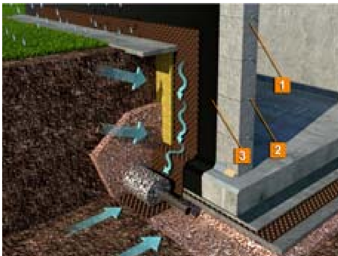
1 - Блоки ФБС 2 - Набухающий гидроактивный профиль 3 - ЭПДМ-мембрана
